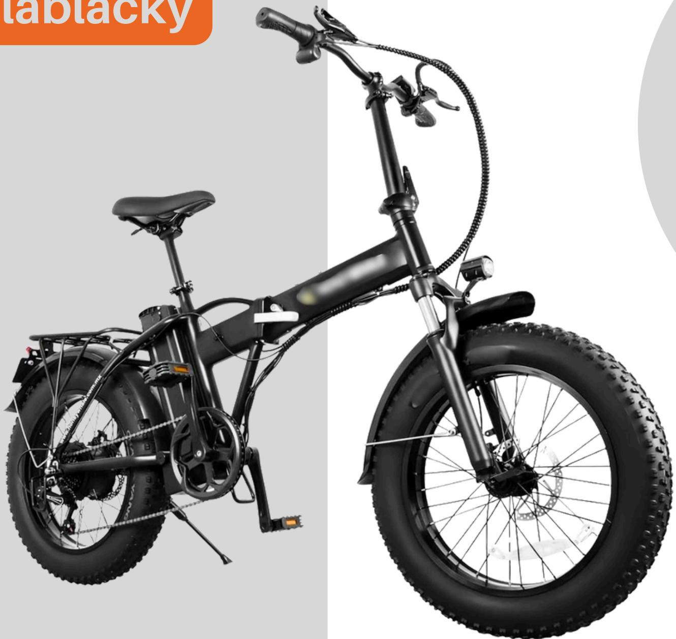
Bicicleta eléctrica, con batería desmontable, plegable en su totalidad y con tres formas de manejo (eléctrico, asistencia de pedaleo y mecánico) y 5 velocidades, con suspensión delantera, y neumático todo terreno (20 pulgadas), con autonomía de aproximadamente 40 kilómetros, frenos traseros y delanteros.
