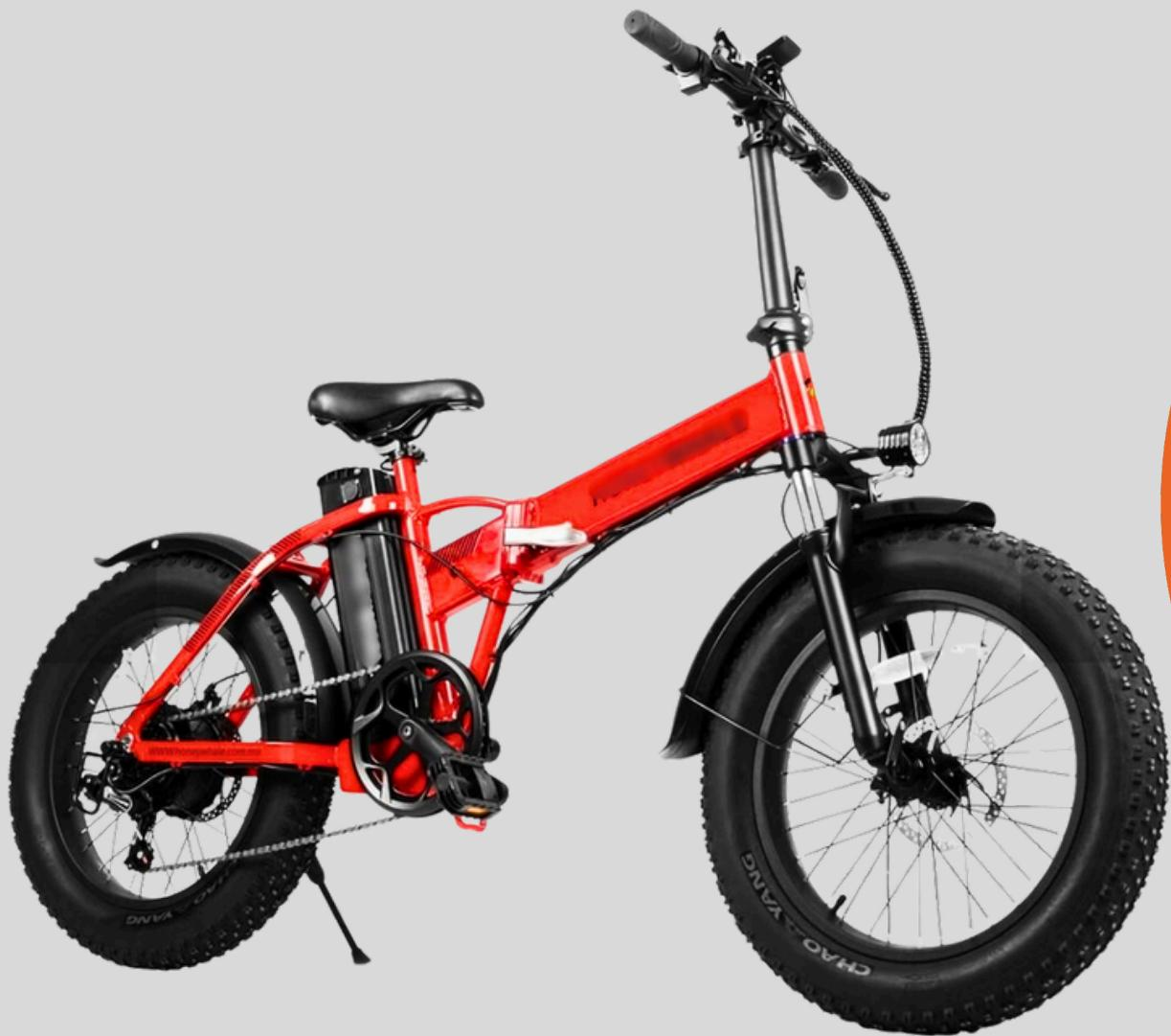
Bicicleta eléctrica, con batería desmontable, plegable en su totalidad y con tres formas de manejo (eléctrico, asistencia de pedaleo y mecánico) y 5 velocidades, con suspensión delantera, y neumático todo terreno (20 pulgadas), con autonomía de aproximadamente 40 kilómetros, frenos traseros y delanteros.
