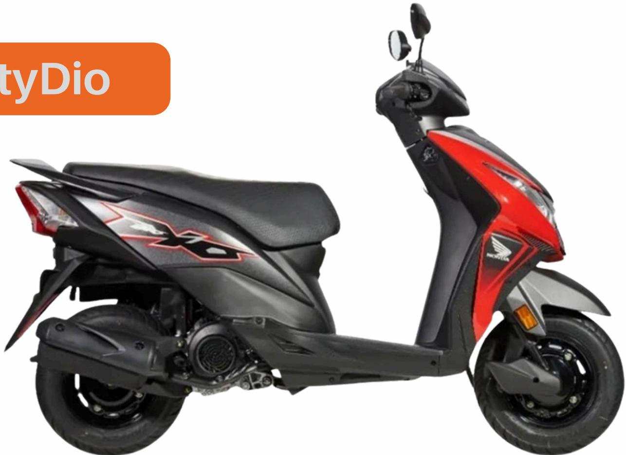
La Honda Dio 110 modelo 2026 incorpora un motor 4 tiempos de 109.2 cc con buena respuesta en ciudad, enfriamiento por aire y arranque eléctrico y de pedal. Su diseño ligero y estable ofrece un manejo cómodo, eficiente y confiable para un buen recorrido por la ciudad.
