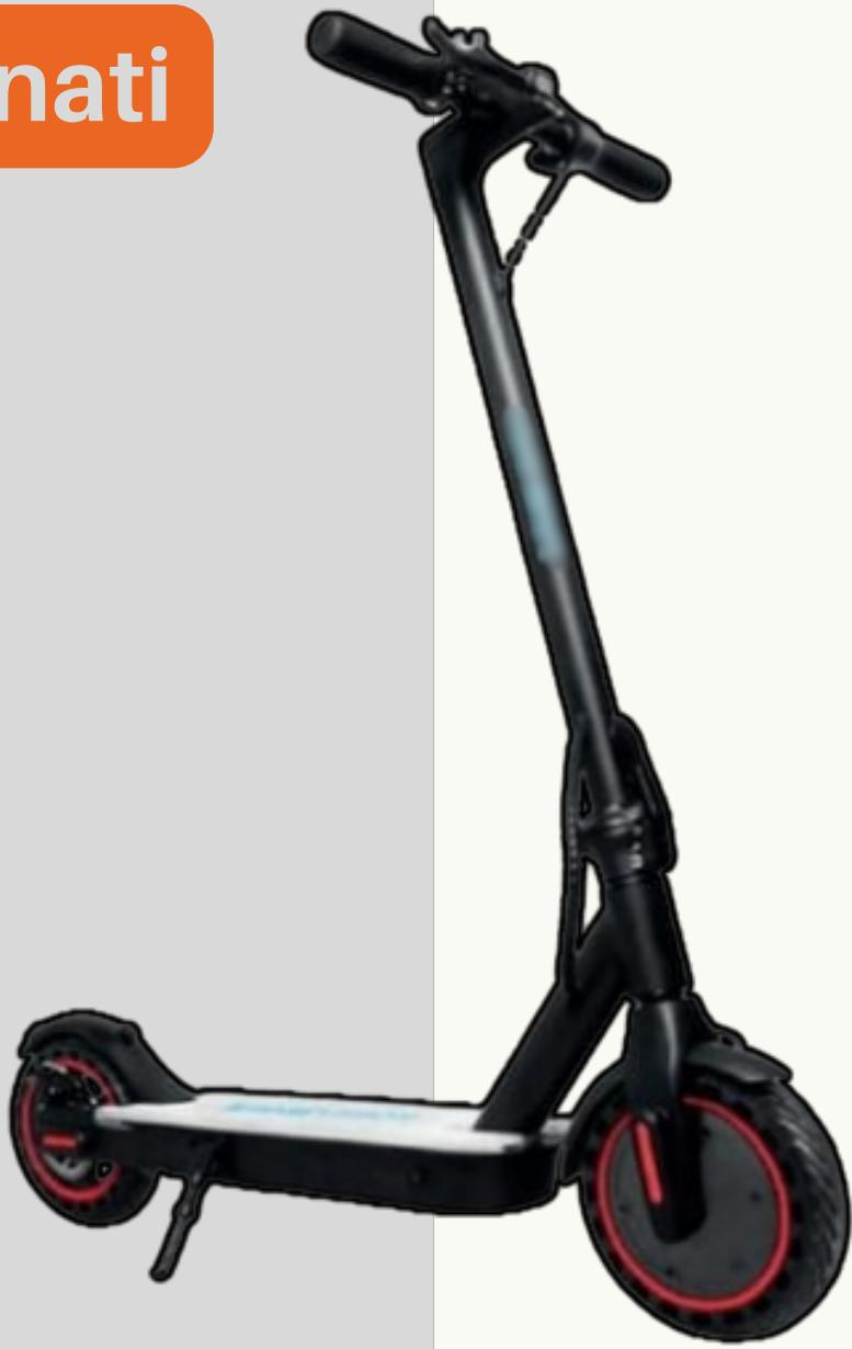
Scooter eléctrico, diseño compacto, con tres velocidades, ideal para terreno plano, con una velocidad máxima de 20km y una autonomía de 15 kilómetros aproximadamente, neumáticos de goma (que evitara pinchazos), tiene luces que iluminan su base (colores verde, azul, morado y rojo), cuenta con freno mecánico de disco en la rueda trasera, (luz led frontal).
